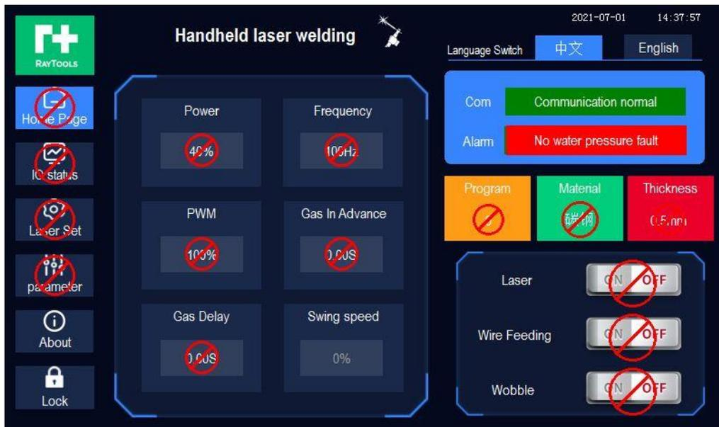
Lock (ロック) : 画面をロックし、HMIを操作できません。これは主に、オペレーターの操作中に他の人が誤って画面に触れて、溶接中にレーザービームがオフになったり、オペレーターの試運転時にレーザービームが放出されたりするのを防ぎ、オペレーターの安全を確保します。
